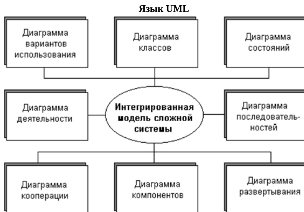
Рис. 1. Интегрированная модель сложной системы в нотации языка UML
