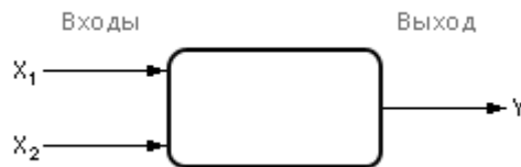
Рис. 3.1. Позначення двовимірної моделі чорного ящика на схемах
